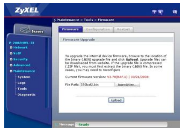
Firmware-Update über Menü Maintenance>Tools
